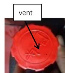
Fig. 41 Bouchon du réservoir de carburant
