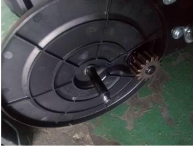
Fig. 39-1 Ajouter de la graisse à l'engrenage
