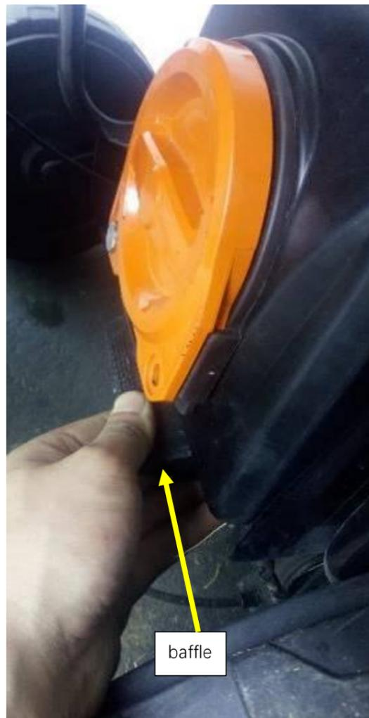
Fig.10-5 Appuyer sur le déflecteur et ouvrir le couvercle arrière
