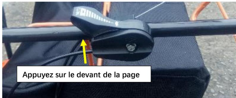
Fig15-2 Poignée d'accélérateur-démarrage du moteur
