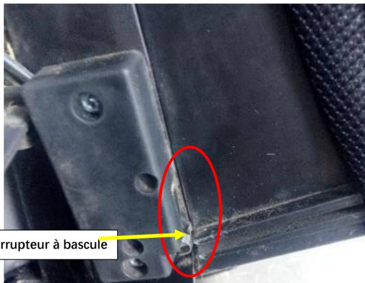
Fig. 14-2 Interrupteur à bascule - état fermé
