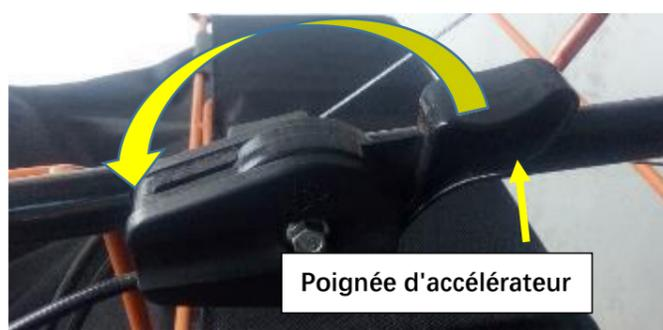
Fig. 15-1 Poignée d'accélérateur-Arrêt moteur
