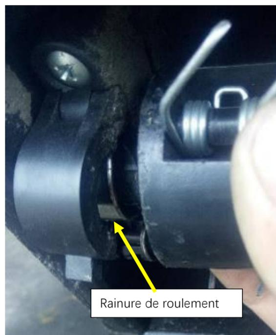
Fig.11-4 Roulement à encliqueter
