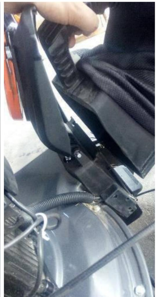
Fig.10-6 Insérer le support du cle arrière
