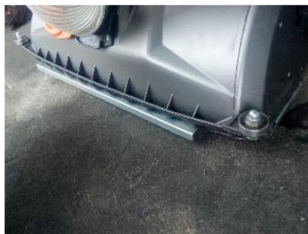
Fig. 30-2 Le déflecteur est inséré en place
