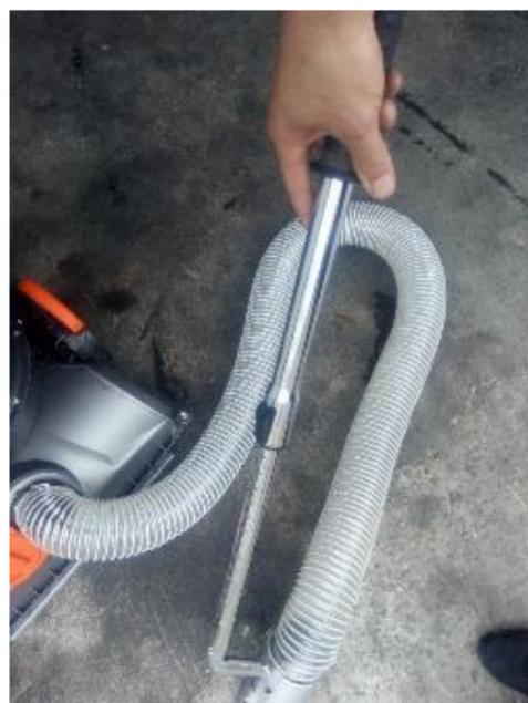
Fig32-2 Régler la hauteur télescopique
