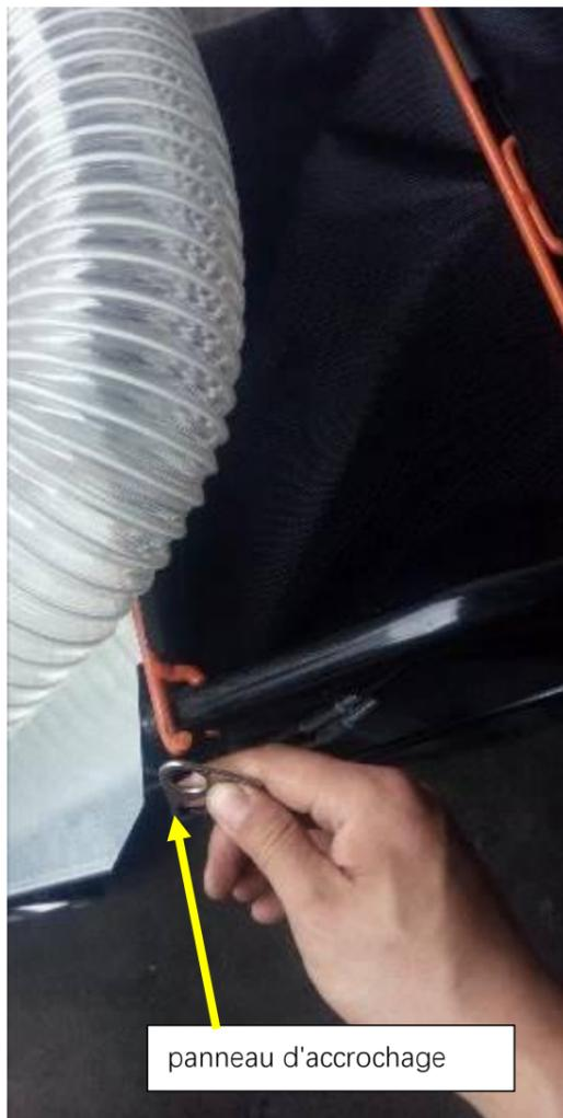
Fig.10-4 Montage du panneau d'accrochage gauche
