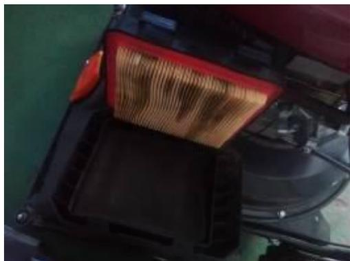
Fig. 40-1 Ouvrez le couvercle latéral du filtre à air
